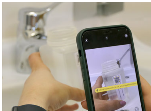
Probenahme zur Prüfung von Trinkwasser mit digitaler Erfassung von Probandaten – Zuordnung des Probenbehälters zum Datenset über QR-Code.
